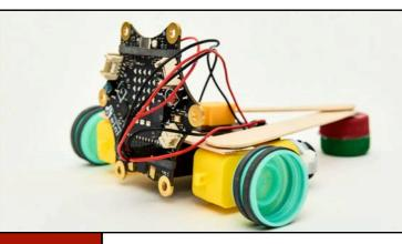
KÜRZE DEN HOLZSPATEL AUF 5,5 CM- (EIN HOLZSPATEL REICHT FÜR ZWEI HALTERUNGEN-) KLEBE DIE GUMMIRINGE AN DIE ENDEN DES HOLZSPATELS-HALTE DIE GUMMIS GESPANNT, BIS DER KLEBER FEST IST-
