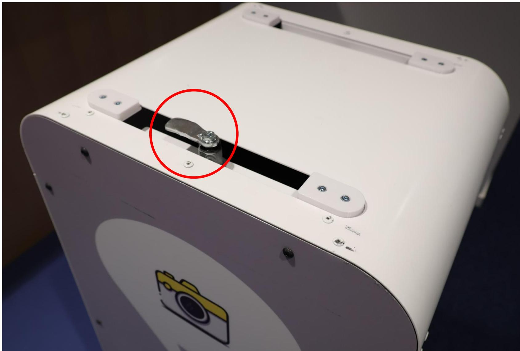
Unterbau der Fotobox an Einsatzort platzieren und Verriegelung in die im Bild gezeigte Stellung bringen.
