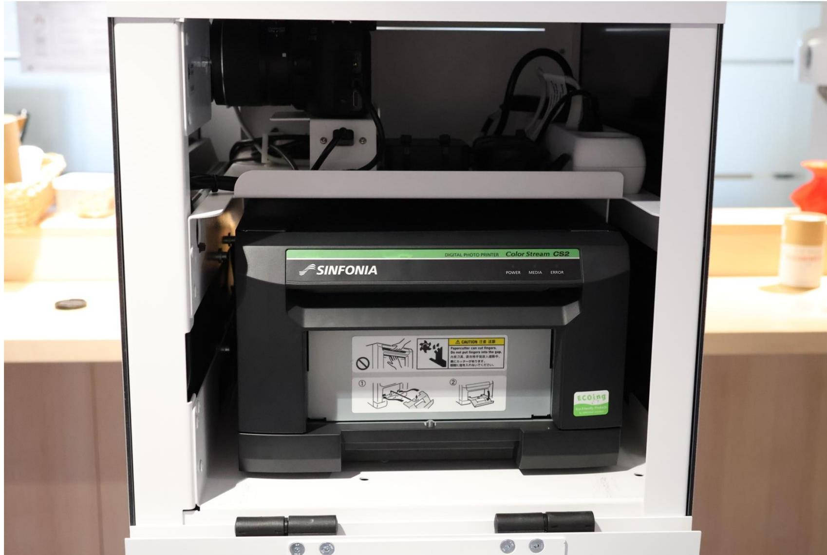
Drucker vorsichtig in die Fotobox schieben und für die korrekte Positionierung die Markierungen auf der Bodenplatte beachten.
