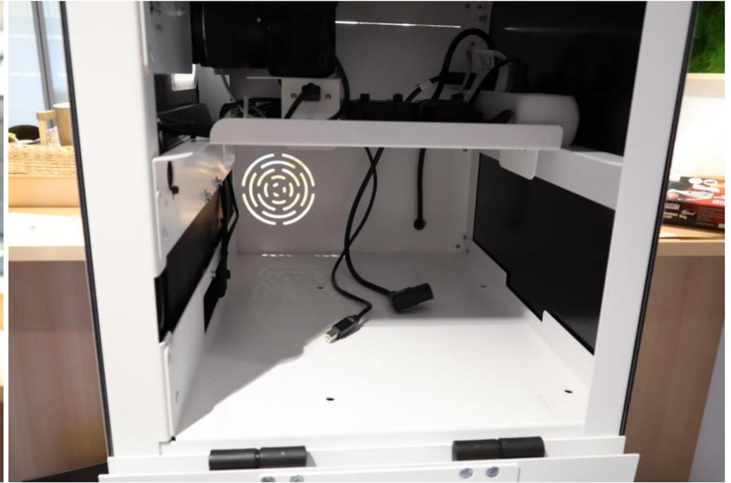
Klappe an der Seite der Fotobox öffnen und Strom- und Datenkabel wie im Bild vorbereiten.
