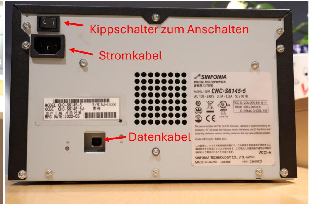
Drucker durch Kippen des Schalters auf 1 anschalten und an der Kante der Öffnung festhalten.
