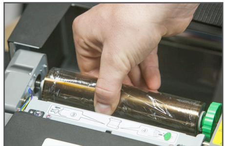
Nach dem gleichen Prinzip setzt du auch die Rolle oben ein. Das Band sollte nicht straff gespannt werden. Lass eine leichte Welle in dem Farbpapier zu.
