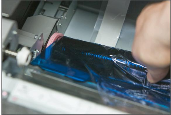
In der Verpackung findest du das Farbband. Nimm dieses heraus und setze es in den Drucker ein. Das Band hat eine rosa Markierung. Diese Seite muss in den Drucker unten links eingesetzt werden. Mit einem leichten Druck wird die rosa Seite nach links geschoben und somit das Farbband passend eingesteckt.
